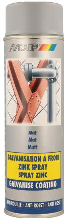
Schnell trocknendes Zinkspray mit guter Füllkraft und ausgezeichneter Haftung für den professionellen Einsatz. Zur Behandlung von verzinktem und unbehandeltem Stahl. Das Zinkspray bietet einen hervorragenden kathodischen Korrosionsschutz, ist punktschweißfähig und beständig gegen Benzin, Chemikalien und Witterungseinflüsse. MOTIP Industrial Zinc Spray ist hitzebeständig bis 350 °C.
